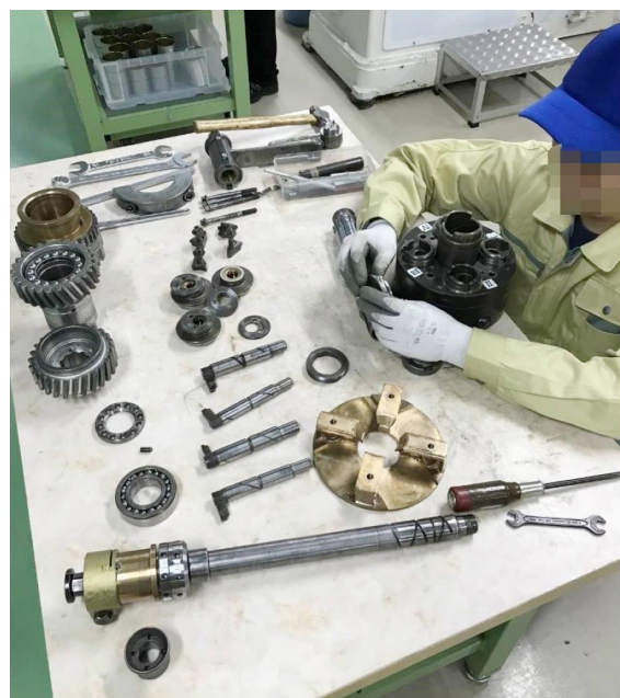
図3 14Mシーマー巻締部（ヘッド）分解の様子
